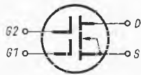
Bild 3. Prinzipschaltung eines Doppel-Gate-Mosfet von RCA (in anderen Veröffentlichungen wird ein solcher Transistor als Tetroden-Mosfet bezeichnet)
