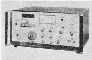
Bild 10. Präzisionsmeßgenerator für 10 Hz...40 MHz Typ MG-164 von Wandel u. Goltermann
